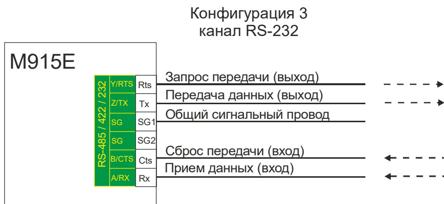
Рисунок 5 - Подключение внешних цепей к интерфейсу RS-232
